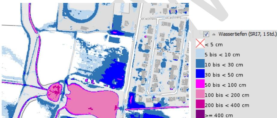
**Abb. 12: Außergewöhnlicher Starkregen (SRI7, 1h), Wassertiefen<sup>6</sup>**
